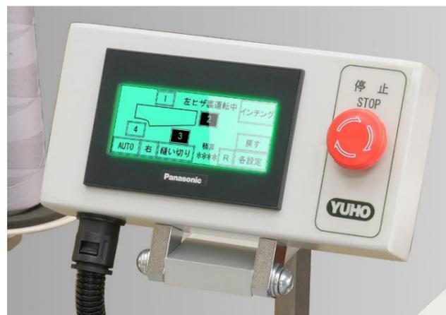
縫い切り、コーナー停止 を液晶画面内のスイッチで切り替えると、各コーナーでの自動停止、または普通サージングのような縫い切りサージングのどちらかを選択可能。スタート条件に関しては、どちらも光電センサーON で自動スタート、またはペダル操作によるスタート、の選択が出来ます。また本機は右身頃、左身頃それぞれに専用の制御プログラムを搭載。液晶画面の「右」「左」、AUTO ボタンの切り替えで、\*右見頃の連続運転、\*左見頃の連続運転、\*左右交互自動切換えでの連続運転、これらを簡単に切り替えることが可能です。
