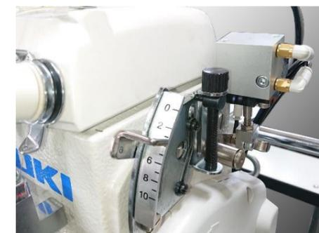
新型上下作動送りオーバーロックミシン頭部は、7,000 rpm の超高速性能を誇ります。上下作動送り機構により適度なヒザ裏のゆとりを付け、裏地のツリやネジレの無い綺麗なサージングが行えます。また、前身のポケット部では上下イセ込みを自動で行うことが可能。左右の身頃共に表地を上にして縁かがりを行い、糸の表面を揃えたサージングを行うことが出来ます。
